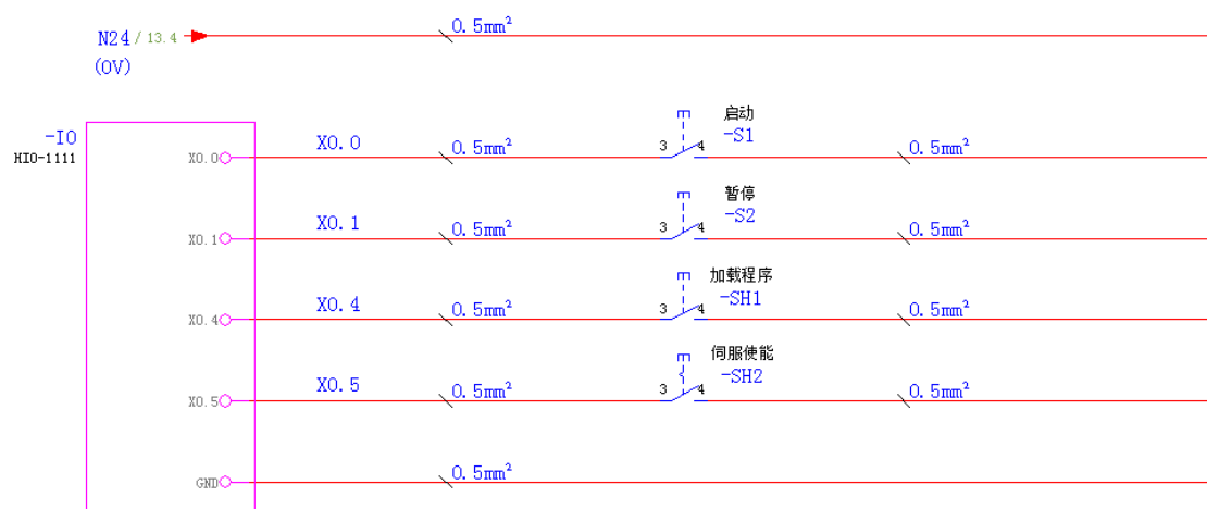
图 5-1 HIO-1111 子模块（NPN 型）输入信号连接电路图
