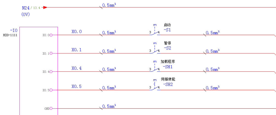
图 5-1 HIO-1811N 子模块（NPN 型）输入信号连接电路图
