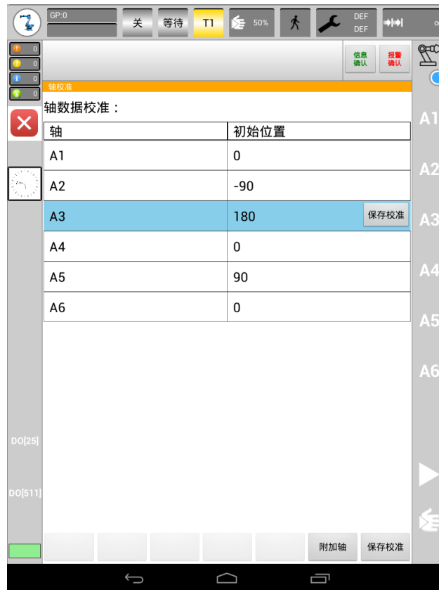
图 4-3 单轴/轴零点校准数据
