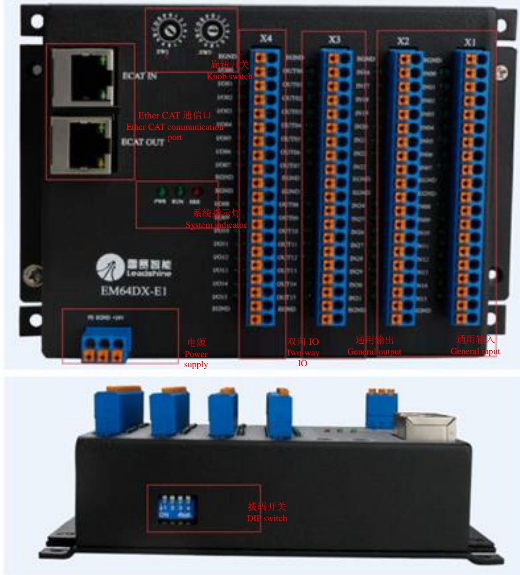
图 2-10 雷赛 EM64DX-E1 总线式 IO 单元接口分布
