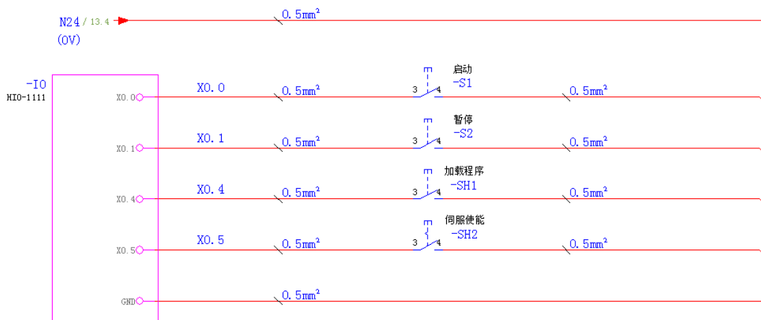
图 5-1 HIO-1111/HIO-1811N 子模块 (NPN 型) 输入信号连接电路图
