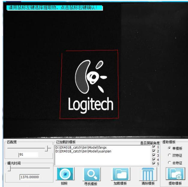
图 2.14 “单模板”提取模板：圈选提取物
