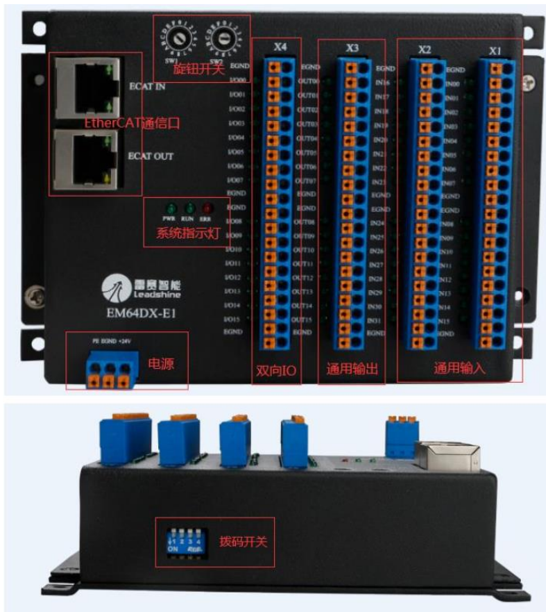
图 2-10 雷赛 EM64DX-E1 总线式 IO 单元接口分布
