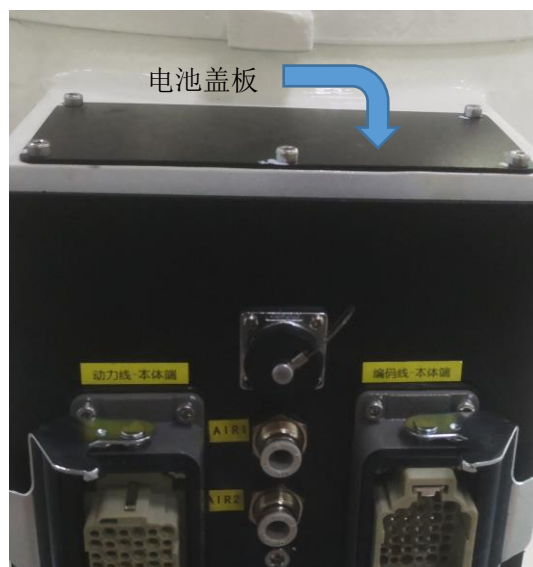
图 4-1 电池更换示意图
