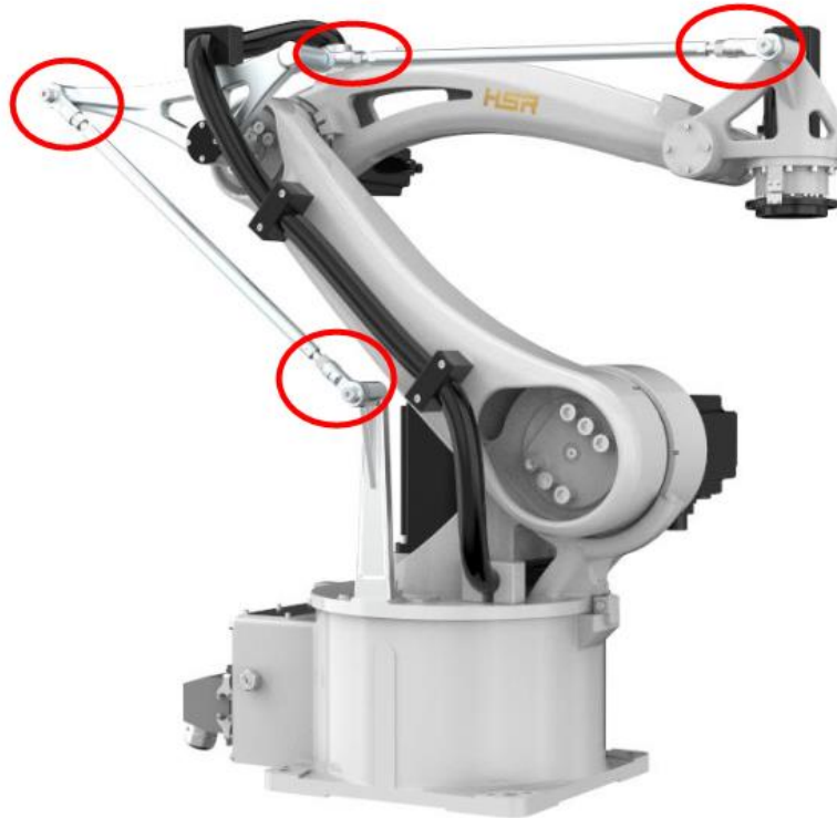
图 4-4 机器人本体鱼眼轴承维护部位
